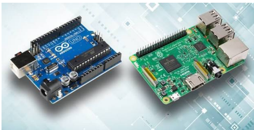
FIGURE 8 – Exemples d'unités de traitement : Microcontrôleur Arduino (à gauche) et Micro-ordinateur Raspberry Pi (à droite).
